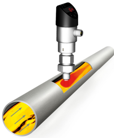
Fig. 3: Chave de fluxo calorimétrica – também mencionada como monitores de fluxo – são geralmente usadas como monitores da presença de um fluxo em uma tubulação Fonte: WIKAI
