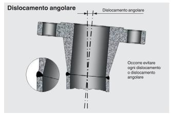
Se vi sono irregolarità sulla saldatura normalmente il collare di supporto viene rilavorato riducendone il diametro ma così facendo l'accoppiamento fra le parti non sarà idoneo perché non fisicamente a contatto, quindi il pozzetto è inutilizzabile.
