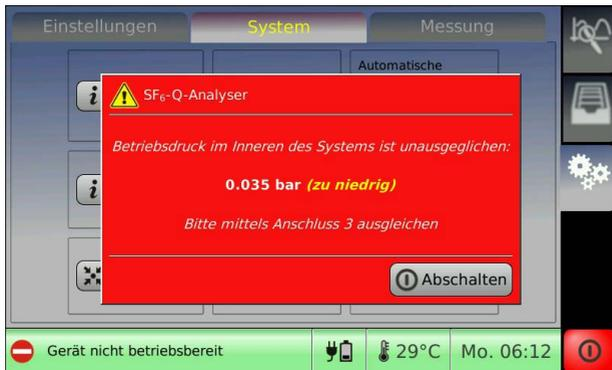
Für Druckausgleich einen Gasauffangbeutel mit gewünschtem Gas (unter atmosphärischen Druck, max. 1.200 mbar abs. oder 200 mbar rel.) an Ausgang für Gasauffangbeutel ③ anschließen.
