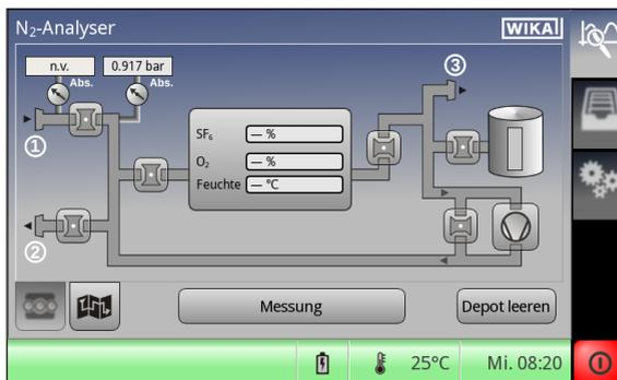
2. Gasraum auswählen, in den das Messgas zurückgepumpt werden soll (nur wenn Rückpumpfunktion ausgewählt wurde).
