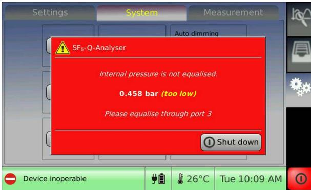
Para la compensación de presión, conectar una bolsa de recolección de gas con el gas deseado (bajo presión atmosférica, máx. 1.200 mbar abs. o 200 mbar rel.) en la salida para bolsa de recolección de gas ③.
