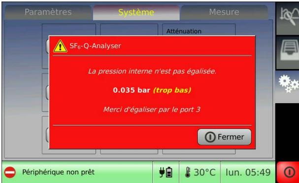
Pour la compensation de pression, raccorder un sac de récupération de gaz avec le gaz souhaité (sous pression atmosphérique, max. 1.200 mbar abs. ou 200 mbar rel.) à la sortie prévue pour le sac de récupération de gaz ③.
