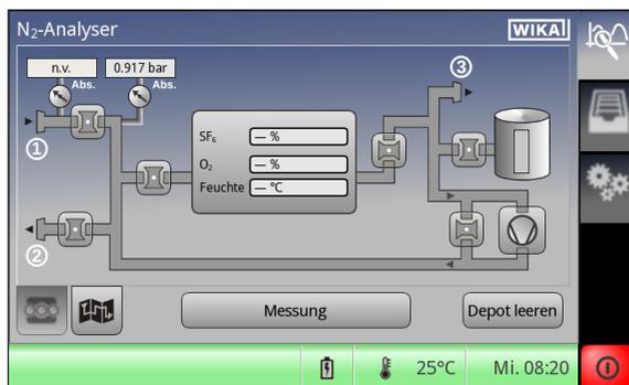
2. Sélectionner le compartiment de gaz pour le repompage du gaz de mesure (disponible seulement si la fonction "repompage" est activée).
