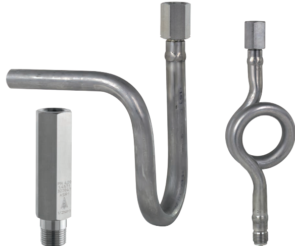
Sifones, modelo 910.15, acero inoxidable Fig. izquierda: versión compacta Fig. centro: forma U, DIN 16282 forma B Fig. derecha: forma de trompeta, DIN 16282 forma D
