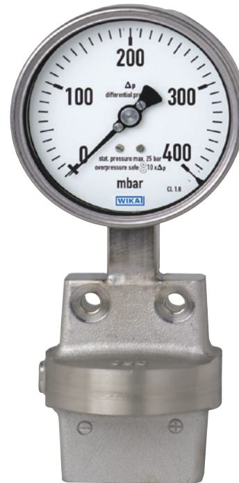
Manómetro de presión diferencial modelo 732.51
