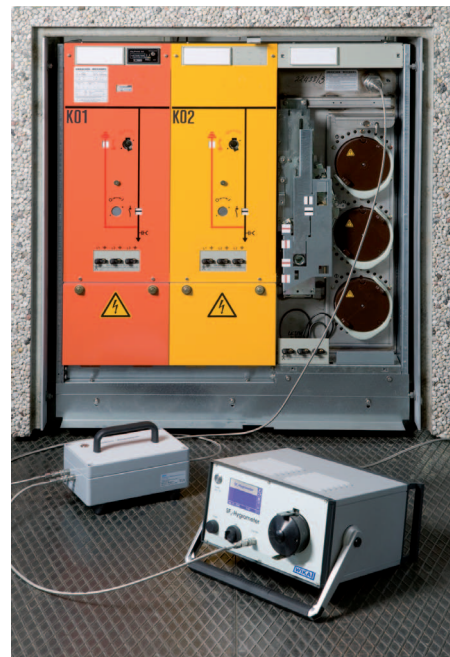
Sistema di misura con regolatore della pressione di alimentazione modello GA05 ed analizzatore modello GA40
