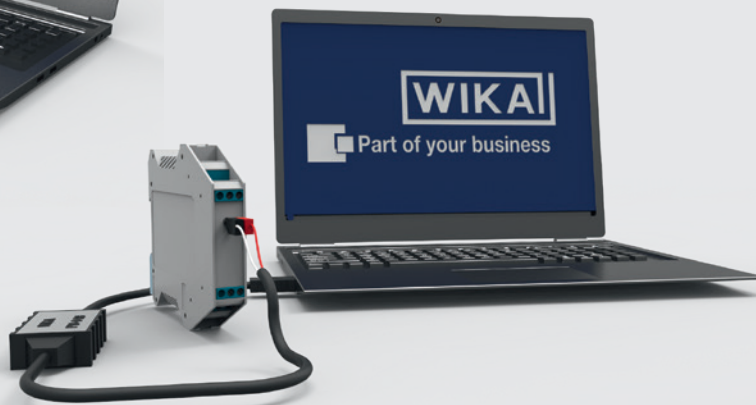
Versione per montaggio su guida DIN, modello T15.R
