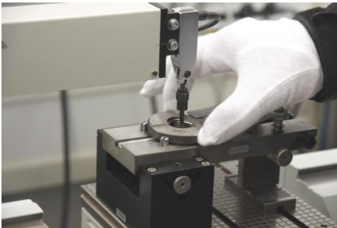
Fig. 2 O limite da rosca de um calibrador anel cônico está alinhado na mesa de seno. Fonte: WIKAI
