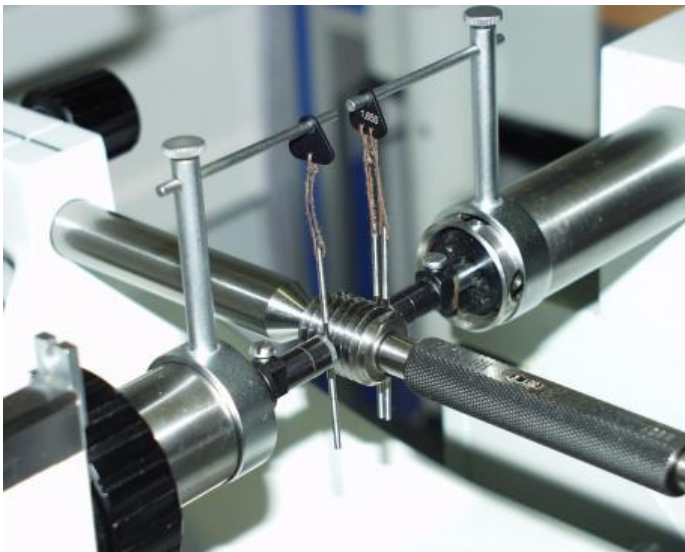
Fig. 3 Um calibrador de rosca tampão cilíndrico é calibrado usando o método de medição de três fios. Fonte: WIKAI
